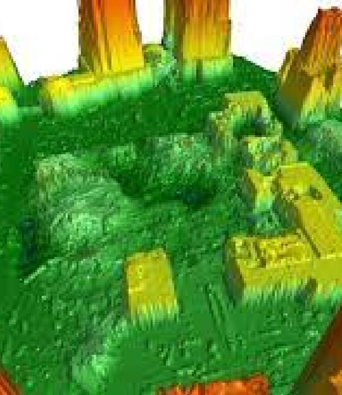
LIDAR es una tecnología que permite medir la distancia entre un sensor y un objeto, a través de un rayo de luz láser para obtener medidas de posicionamiento georreferenciadas mediante modelos digitales tridimensionales de alta precisión.
