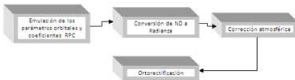
Figura 2: Flujograma del pre-procesamiento de la imagen SPOT-5
