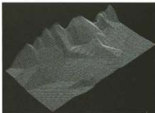
Figura 9: DEM de la zona de estudio. Se observan los cambios de pendiente existentes en las zonas problema, que se presentan en la parte inferior y superior izquierda de la imagen.
